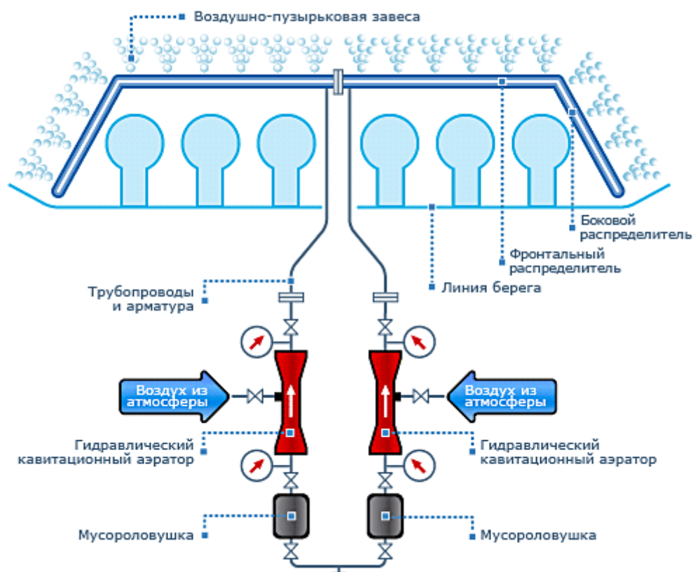
Рисунок 43 - Схема воздушно – пузырькового рыбозащитного устройства
