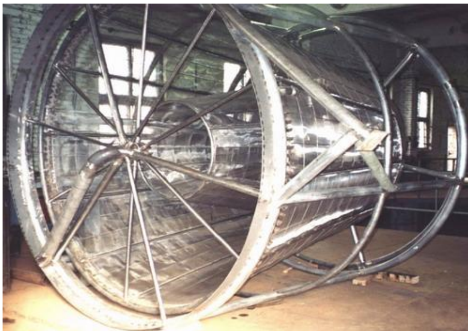
Рисунок 42 - Многополостное конусное РЗУ типа «Кокон», установленное на Рублевской водопроводной станции (г. Москва)
